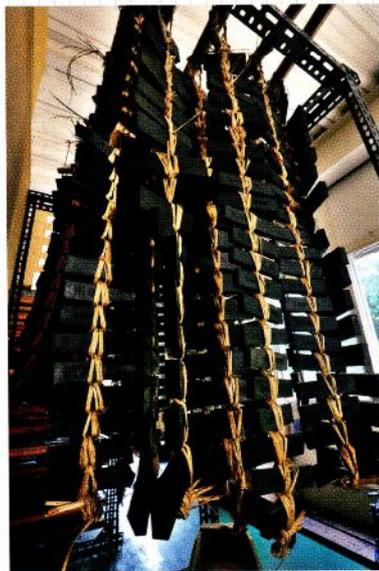
← 空気を絶ち、灰を被せて湿気を取る。灰乾燥を終えた墨は、数か月自然乾燥させる。元の約6割の重さになったら、磨き、鉛を彩色する。
