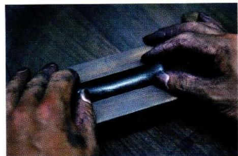
↑ 練り込みを終えた墨は、天秤で量り分け、手でこねて木枠に収める。その後、ネジと呼ばれるプレス機でしばらく圧縮する。
